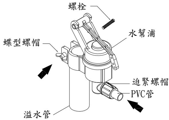
12.將PVC軟管用迫緊螺帽鎖固於水幫浦進水端.
