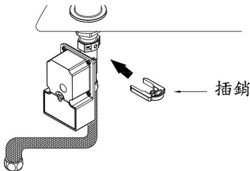
10.將高壓軟管另一端鎖固於止水栓則進水部安裝完成(注意避免高壓軟管折管)
