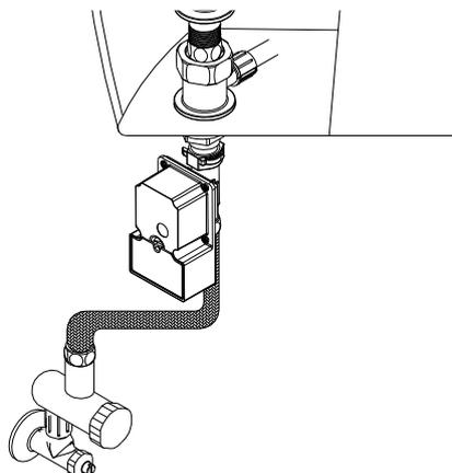
11.取出水幫浦組依圖示套入排水部之溢水管上方,確認高度後以螺絲及蝶型螺帽鎖固之.
