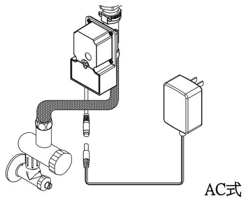
2. 檢視水箱內進水狀況, 並確認進水器止水功能是否正常(止水後水位線不可再上升或馬桶不能有滴漏狀況)水位線的高度會影響沖水量的大小, 可於進水器上方螺桿調整適當之水位高度.
